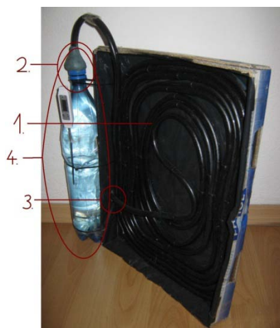
Obr. 1 Časti jednoduchého solárneho kolektora (1. Absorbér kolektora (je celá plocha kolektora, t.j. čierna hadica + dno kolektora), 2. Odvod ohriatej vody, 3. Prívod studenej vody, 4. Zásobník na vodu)
