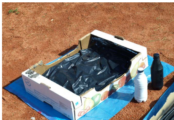
Obr.3. Realizácia vrecového kolektora
