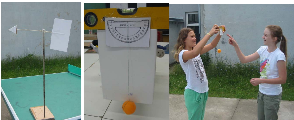
Obr. 1: veterná smerovka, kyvadlový anemometer, určovanie rýchlosti vetra
