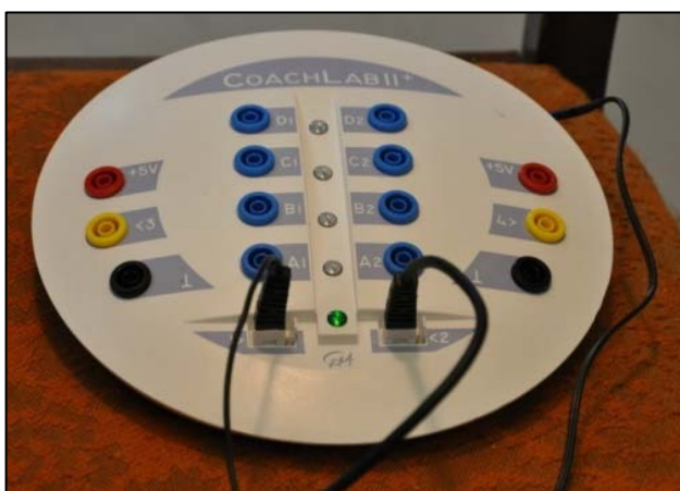
Obr.2: Interfejs Coach-lab II+ s pripojenými senzormi sily
