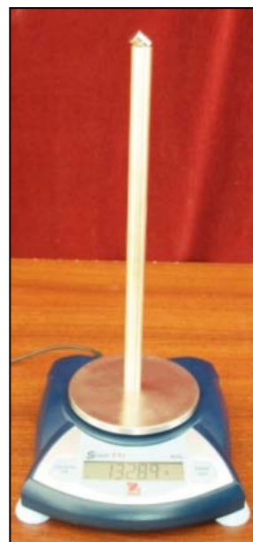
Obr.3: Aparatúra na meranie hmotnosti sústavy: digitálne váhy, kovová rúrka a neodýmový magnet
