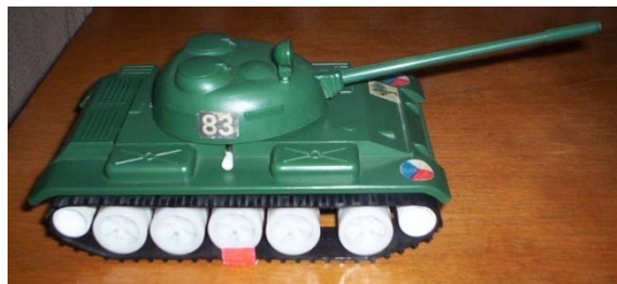
Obrázok 13: Časť pásu, ktorá je na zemi, je pri pohybe tanku vzhľadom na zem v pokoji.
