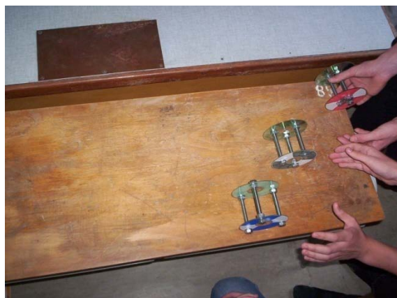
Obrázok 8: Koleska na konci naklonenej roviny. Najrýchlejšie bolo kolesko so skrutkami pri osi.
