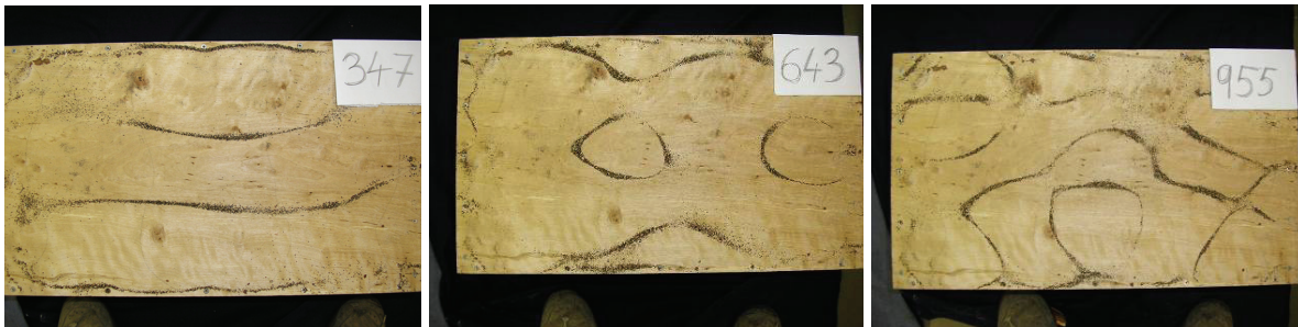
Obr.4: Niektoré tvary módov použité pri ladení dosiek korpusu cajonu
