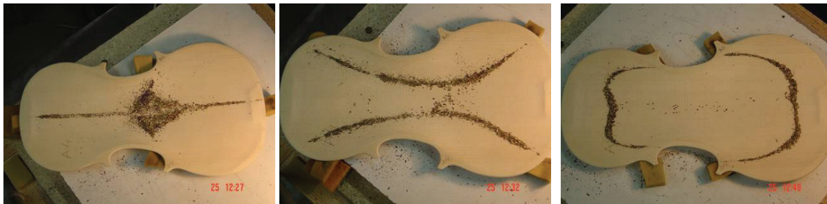
Obr. 5: Módy 1., 2. a 5. voľnej spodnej husľovej dosky
