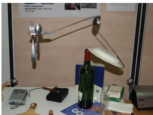
Obr.10 Ťažisko a rovnovážna poloha telesa
