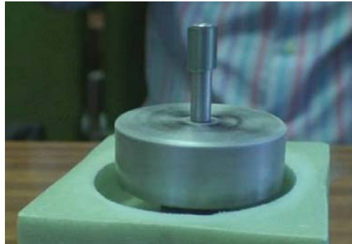
Obr. 12 : Levitujúci magnet, ktorý nesie 100 g hliníkový disk.
