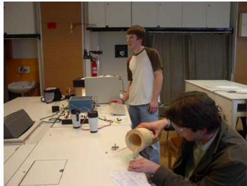
Obr. 13 Základné experimenty prezentujú študenti ŠP Fyzika materiálov Mgr. Miroslav Boboň (vpravo) – magnetickú levitáciu; Bc. Peter Krupa – meranie teplotnej charakteristiky odporu a T_c vzorky HTSC.
