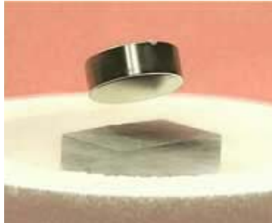
Obr. 10 Levitácia magnetu nad doštičkou HTSC.
